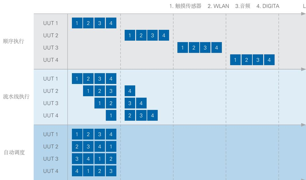
图5. 并行测试功能可显著增加系统吞吐量，而且无需重新构建测试执行软件的架构。
