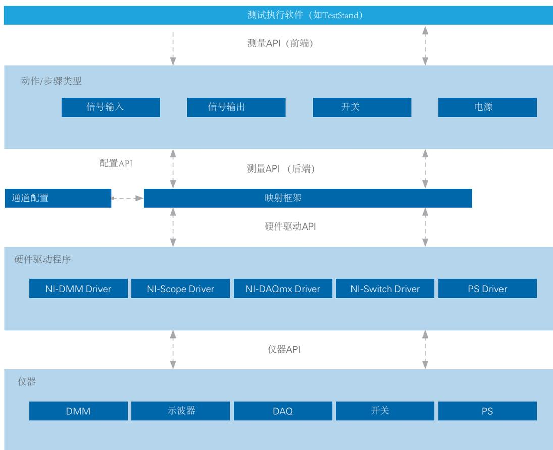
图14.采用集成式MAL和HAL的自动化测试软件概述
